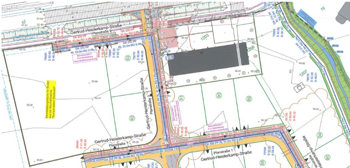
(ISW. Erschließung BW 44 „Musekamp“ – Abwasserbeseitigung. Lageplan Endausbau. 30.07.2025)
